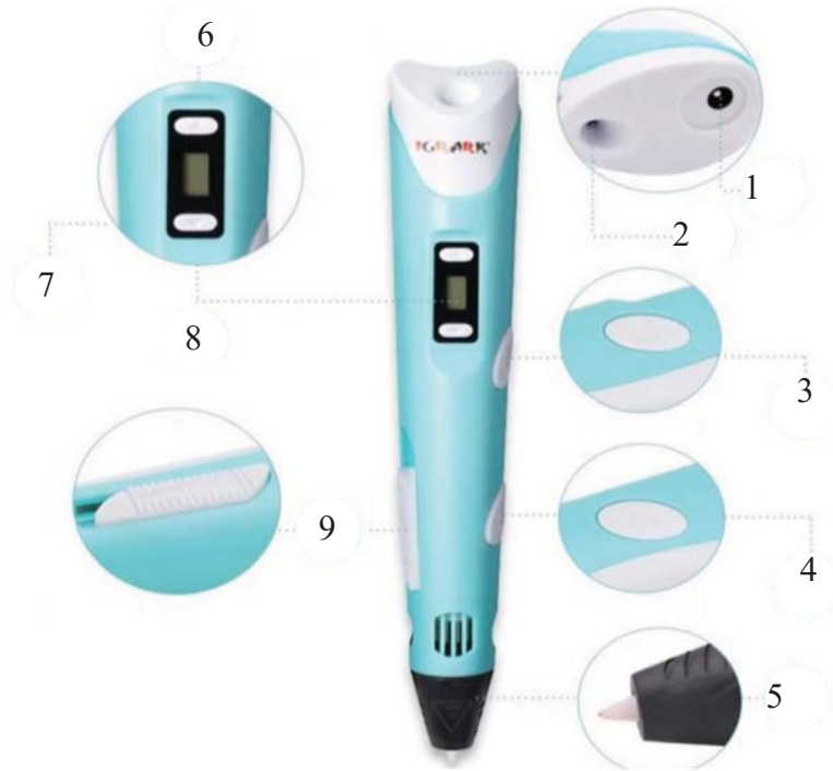
103-rasm. Issiq 3D ruchka tuzilishi: 1 – quvvat manbayi; 2 – plastik sim teshigi; 3 – plastik simni orqaga qaytarish tugmasi; 4 – plastik simni oldinga o‘tkazish tugmasi; 5 – ishchi qismi; 6–7 – haroratni rostdlash “+”, “–” tugmalari; 8 – LED ekran, 9 – tezlikni rostdlash tugmasi.
