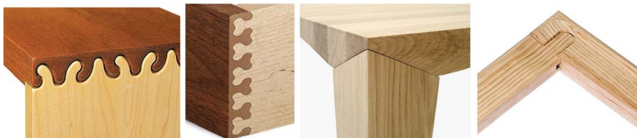
41-rasm. Turli naqsh elementlari ko'rinishidagi tirqoqli birikma turlari.
