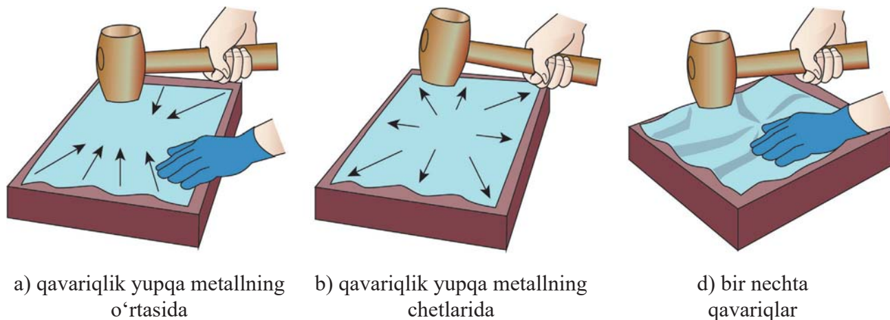
77-rasm. Yupqa metallni to'g'rilash usullari.
