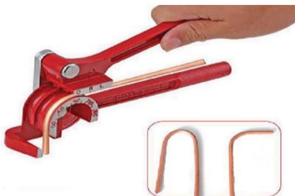
82-rasm. Dastaki truba bukkichda halqa hosil qilish jarayoni.
